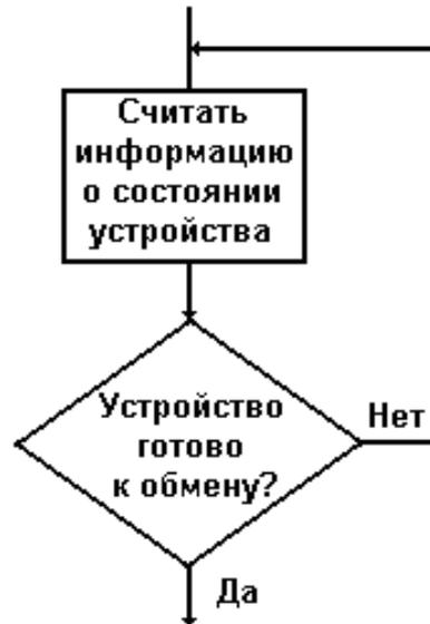
*Рис. 37. Цикл программного ожидания готовности внешнего устройства*
